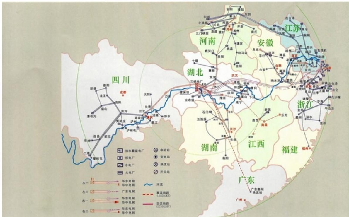
图 1 三峡电站输变电线路图
